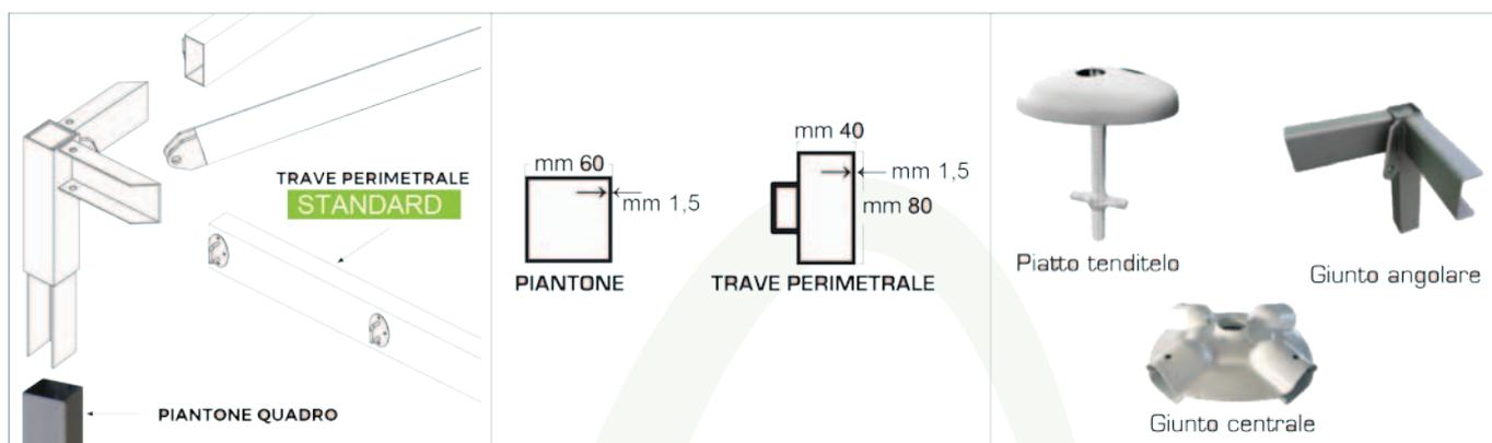
Le coperture standard risultano verificate nei loro elementi strutturali per le azioni di calcolo di cui alla norma UNI EN-13782:2006, (punto 6.4.2.2 - carico vento - e punto 6.4.3.3 carico neve) nella tipologia di strutture rimovibili per utilizzo temporaneo itinerante, per uso pubblico o privato. A richiesta, le coperture per utilizzo permanente per uso pubblico o privato, gli elementi strutturali saranno dimensionati e verificati secondo le norme vigenti nei luoghi di installazione.
