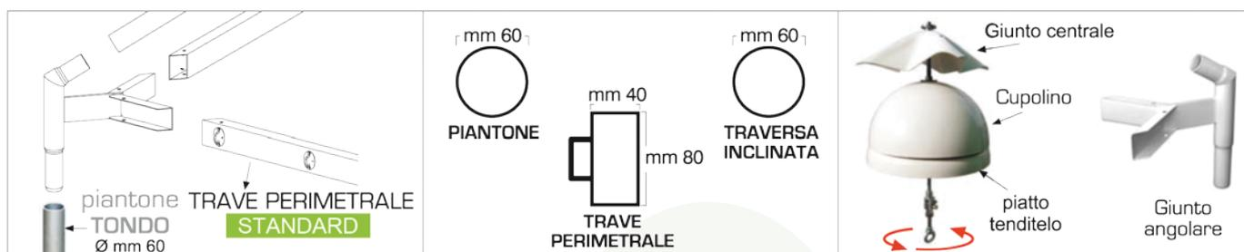
Le coperture standard risultano verificate nei loro elementi strutturali per le azioni di calcolo di cui alla norma UNI EN-13782:2006, (punto 6.4.2.2 - carico vento - e punto 6.4.3.3 carico neve) nella tipologia di strutture rimovibili per utilizzo temporaneo itinerante, per uso pubblico o privato. A richiesta, le coperture per utilizzo permanente per uso pubblico o privato, gli elementi strutturali saranno dimensionati e verificati secondo le norme vigenti nei luoghi di installazione.
