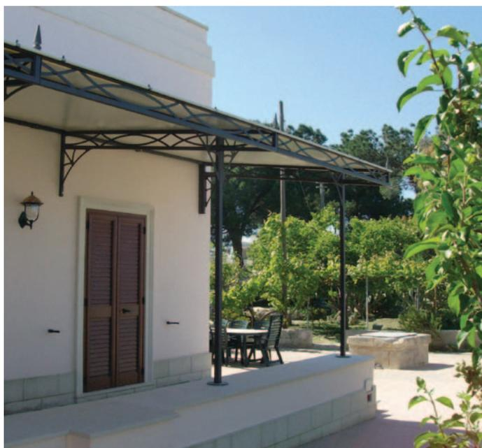
Questo tipo di pensilina a sbalzo viene realizzata con l'intento di dare un tocco di stile e di classe agli spazi antistanti l'ingresso di un ristorante, di una struttura ricettiva, oppure di una semplice casa di campagna. È una pratica pensilina in acciaio, la cui struttura portante viene zincata a caldo, che può essere verniciata con i colori scelti direttamente dal catalogo.
