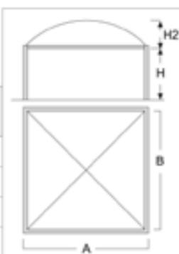
Le coperture standard risultano verificate nei loro elementi strutturali per le azioni di calcolo di cui alla norma UNI EN-13782:2006, (punto 6.4.2.2 - carico vento - e punto 6.4.3.3 carico neve) nella tipologia di strutture rimovibili per utilizzo temporaneo itinerante, per uso pubblico o privato. A richiesta, le coperture per utilizzo permanente per uso pubblico o privato, gli elementi strutturali saranno dimensionati e verificati secondo le norme vigenti nei luoghi di installazione.
